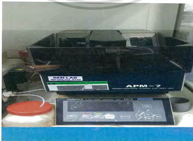
รูปที่ 3.6 เครื่องมือการทดลองหาจุดวาบไฟ TANAKA APM-7
