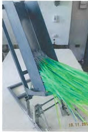
รูปที่ 3.6 ชุดทดลองบรรจุต้นกล้าชนิดกระบะแกว่งปลายตรง
