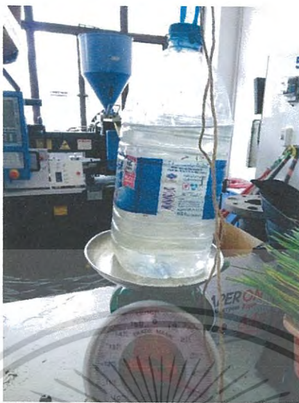
รูปที่ ข.2 น้ำหนักที่ทำให้กลไกการลำเลียงต้นข้าวทำงาน
