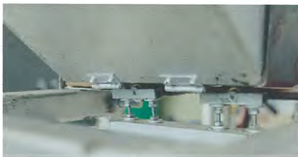
รูปที่ 3.10 การเพิ่มลูกกลิ้งที่ตำแหน่งด้านล่างของกระบะ
