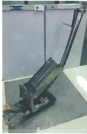
รูปที่ 3.12 ชุดทดลองบรรจุต้นกล้าชนิดกระบะแกว่งปลายเปลี่ยนระนาบ
