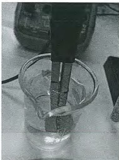
รูปที่ 3.3 แสดงโพรบที่ทำจากสแตนเลส 304
