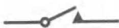
รูปที่ 2.14 สัญลักษณ์หน้าสัมผัสแบบ A (Form A)
