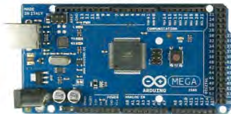
รูปที่ 2.1 บอร์ดอาร์ดูโนเมกา
