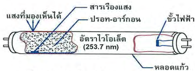
รูปที่ 2.11 โครงสร้างภายในของหลอดฟลูออเรสเซนต์
