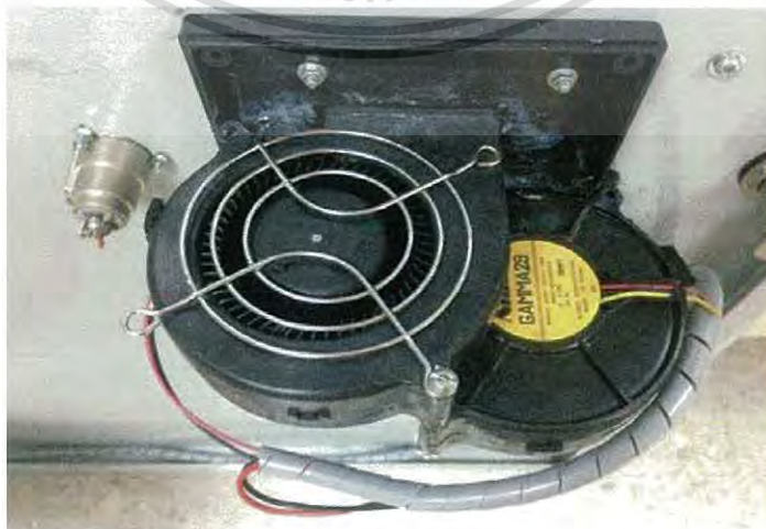
รูปที่ 4.9 ทดลองใช้งานพัดลมระบายอากาศแทน
