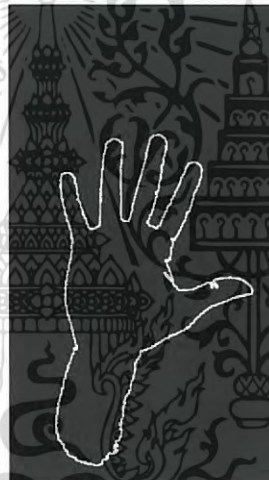
รูปที่ 4.6 แสดงผลลัพธ์ที่ได้จากการหาขอบภาพด้วยวิธีการโซเบล
