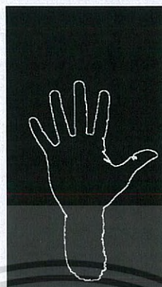
รูปที่ 3.7 แสดงผลลัพธ์ที่ได้จากการหาขอบภาพด้วยวิธีการโซเบล
