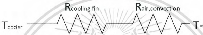
รูปที่ 3.5 แสดงวงจรความร้อนของครีบระบายความร้อน
