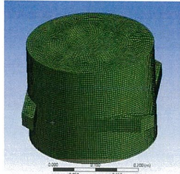
Combustion chamber 162,293 อีลิเมนต์ ขนาดอีลิ ขนาดอีลิเมนต์(5มม. เล็กสุด2 มม.)
