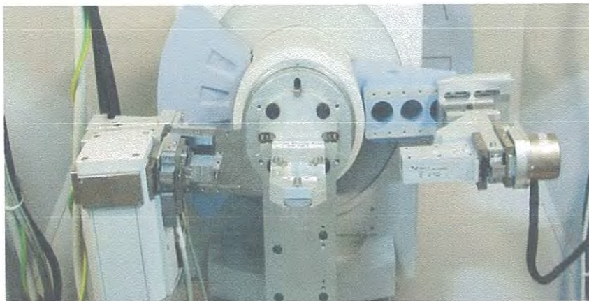
รูปที่ 2.18 เครื่องวัดการเลี้ยวเบนของรังสีเอ็กซ์
