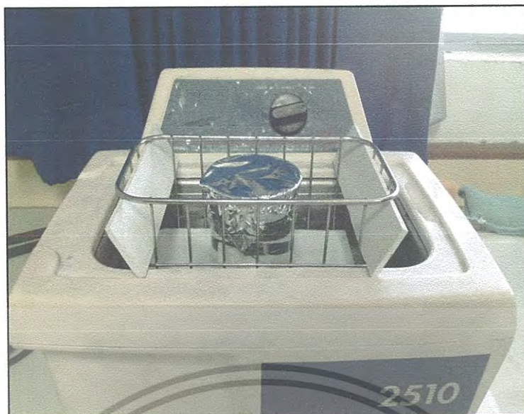
รูปที่ 3.15 ล้างด้วยเมทานอลทำความสะอาดด้วยเครื่องอัลตราโซนิคเป็นเวลา 15 นาที
