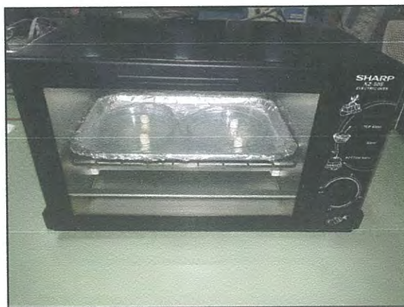
รูปที่ 3.21 นำกระจกสไลด์ที่เคลือบสารแล้วอบด้วยเตาไฟฟ้าห้อ SHARP รุ่น KZ-50s เป็นเวลา 15 นาที
