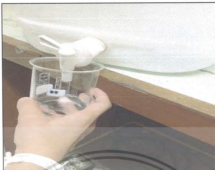
รูปที่ 3.13 ล้างด้วยน้ำสะอาดและล้างด้วยน้ำปลอดประจุ (DI) ด้วยเครื่องทำความสะอาดด้วยเครื่องอตราโซนิกเป็นเวลา 15 นาที
