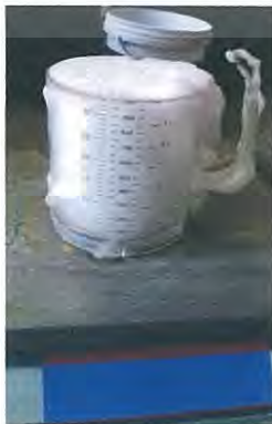
รูปที่ 3.15 การหาความหนาแน่นของโฟมโพรตีน
