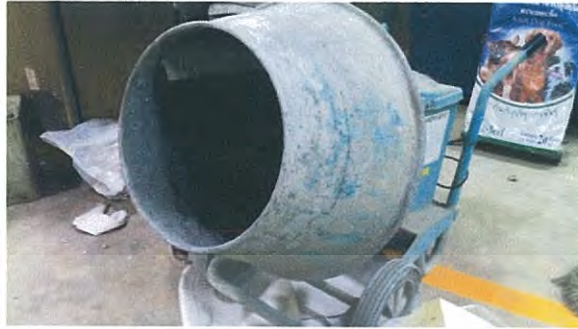
รูปที่ 3.3 เครื่องผสมคอนกรีต
