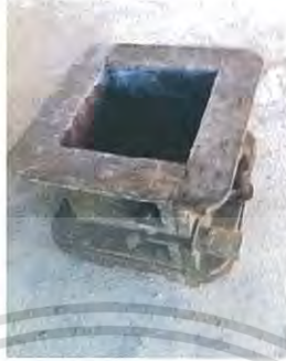
รูปที่ 3.6 แบบหล่อคอนกรีตขนาด 10×10×10 เซนติเมตร
