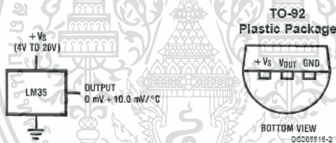
รูปที่ 2.1 โครงสร้างทั่วไปของ LM35
