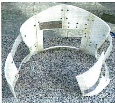
รูปที่ 4.168 ภาพโดยรวมของแกนในอุปกรณ์พวงหลัง ใช้แผ่นซิลิโคนเชื่อมต่อระหว่างแกนแต่ละชั้น
