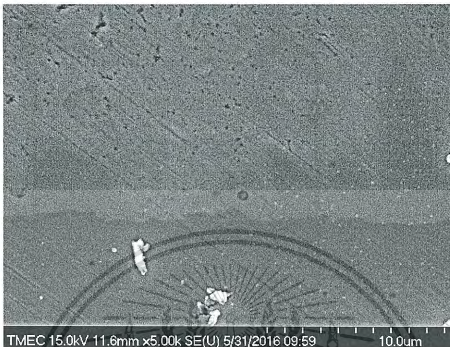
รูปที่ ๙.19 ชั้นสารประกอบเชิงโลหะของโลหะบัดกรี Sn-0.3Ag-0.7Cu-0.5In-0.75ZnO กับแผ่นรองทองแดงหลังการบัดกรี
