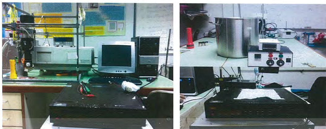
รูปที่ 3.3 แสดงอุปกรณ์ที่ใช้ในการศึกษาความสัมพันธ์ระหว่าง ค่ากระแสไฟฟ้า กับ ค่าแรงดันไฟฟ้า ที่อุณหภูมิห้อง และ อุณหภูมิต่ำในช่วงอุณหภูมิ 20 - 300 เคลวิน ของไดโอดที่มีรอยต่อแบบวิวิธพันธุ์ของฟิล์มบางของสารกึ่งตัวนำ n-ZnSe/p-Si (100) และ อุปกรณ์ที่ใช้ศึกษา ค่ากระแสไฟฟ้า กับ ค่าแรงดันไฟฟ้า ที่อุณหภูมิสูงในช่วง 25 - 300 เคลวิน ของฟิล์มบางของสารกึ่งตัวนำ ZnSe ที่เคลือบลงบนแผ่นฐานรองรับที่เป็นกระจกสไลด์ ที่เตรียมโดยวิธีการระเหยสารเคมีด้วยความร้อนภายในระบบสุญญากาศ
