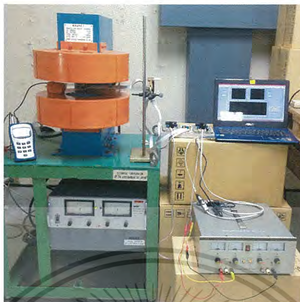
รูปที่ 3.26 ระบบการวัดค่าสนามแม่เหล็กโดยไม่ขึ้นกับทิศทาง
