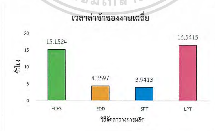
รูปที่ 4.14 เวลาล่าช้าของงานเฉลี่ยที่ได้จากการจำลองด้วยโปรแกรม OptQuest
