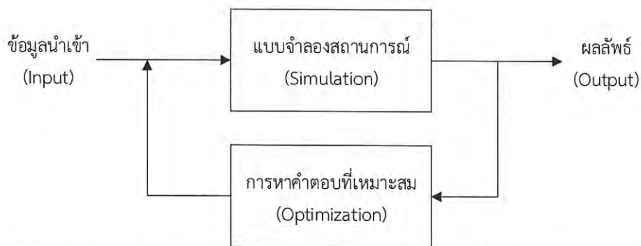
รูปที่ 2.2 ความสัมพันธ์ของแบบจำลองสถานการณ์ และการหาคำตอบที่เหมาะสม [7]
