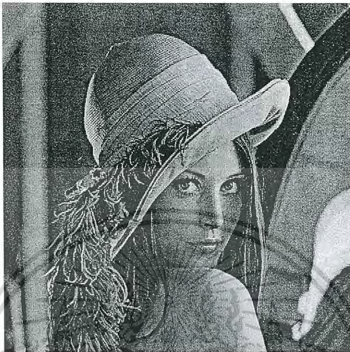
รูปที่ 4.8 แสดงการทดสอบภาพต้นฉบับ (ก) Lena โดยฝังพิตฐานสองแบบสุ่มจำนวน 380,000 บิต PSNR = 23.99 dB
