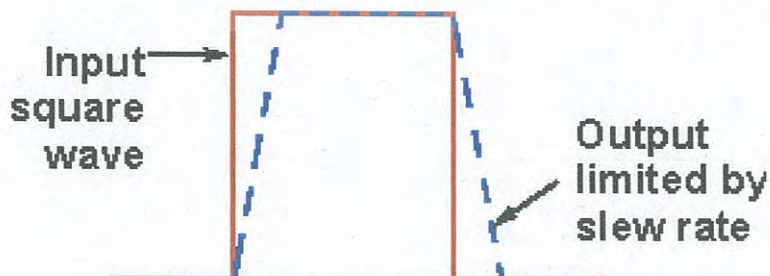
รูปที่ 2.6 ผลกระทบที่เกิดขึ้นเมื่อออปแอมป์มีค่า Slew Rate ที่ไม่เหมาะสมกับความถี่ที่ได้รับ [15]
