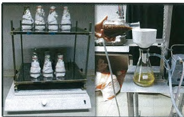
ภาพผนวกที่ ข7 การเขย่าและกรองสารสกัดเบต้าแคโรทีน
