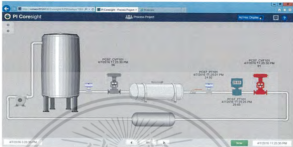
รูปที่ 4.15 แสดงรูปภาพกราฟิกและพารามิเตอร์ในกระบวนการบนโปรแกรม PI Coresight
