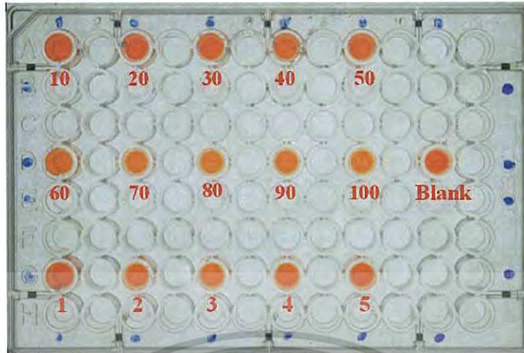
รูปที่ 4.8 ภาพถ่ายการวิเคราะห์หาปริมาณเอทานอลแบบอาศัยการกระเหย (สองแถวบน (A และ D) คือ สารละลายมาตรฐานเอทานอล และแถวล่างสุด (แถว G) คือ ตัวอย่างเครื่องดื่มแอลกอฮอล์)
