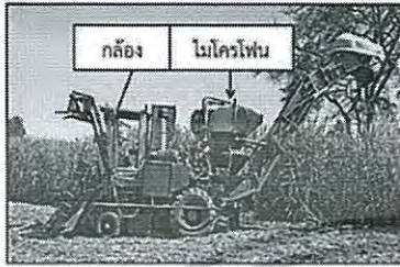
รูปที่ 2 จุดติดตั้งจุดบันทึกภาพและเสียง
