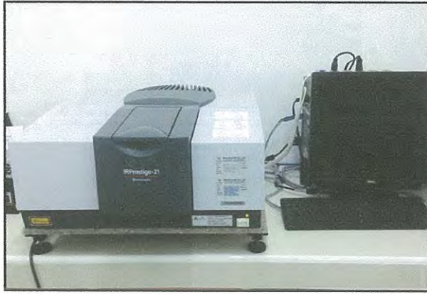
รูปที่ 3.2 เครื่องวิเคราะห์สารด้วยอินฟาเรด
