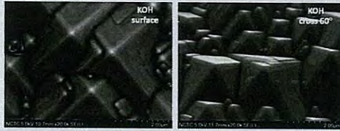
รูปที่ 2 ลักษณะพื้นผิวแผ่นซิลิคอนที่กัดด้วยสารละลาย KOH
