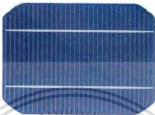
รูป 2.5 เซลล์แสงอาทิตย์ซิลิคอนแบบผลึกเดี่ยว
