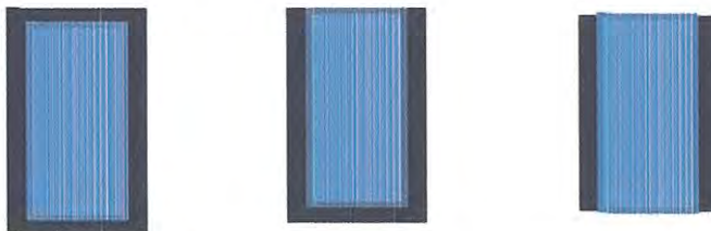
รูปที่ 3.9 แสดงการหุ้ม CFRP แบบต่างๆ
