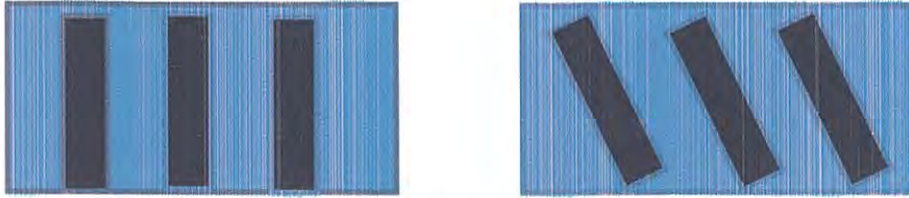
รูปที่ 3.10 การติดตั้งแผ่น CFRP ในแนวตั้ง และแนวรับแรงเฉือน
