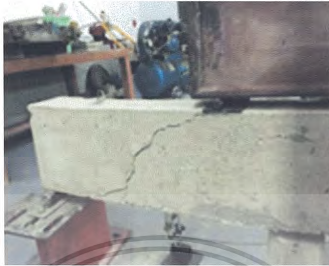
รูปที่ 4.44 แสดงรอยแตกร้าว และการวิบัติของคาน BNOTP 1
