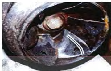
รูปที่ 2.5 การสึกกร่อนบนใบพัดของปั๊ม [9]
