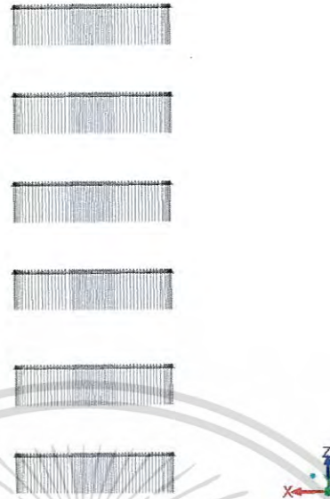
รูปที่ 4.20 ลักษณะการเคลื่อนที่ของอากาศในท่อตรงก่อนติดแชมเบอร์ที่ระยะ -304.8 ถึง -101.6 มม. ตามแกน z
