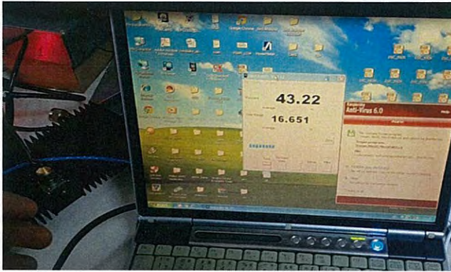
รูปที่ 3.25 การตรวจจับกำลังไมโครเวฟด้วย VPM
