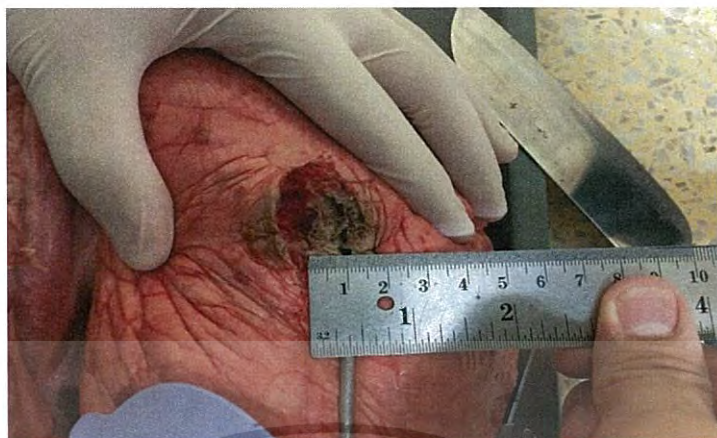
รูปที่ 4.10 ทดสอบการกระจายความร้อนของสายอากาศแบบปลายเปิด (COA) ในเนื้อเยื่อปอด(80วัตต์)
