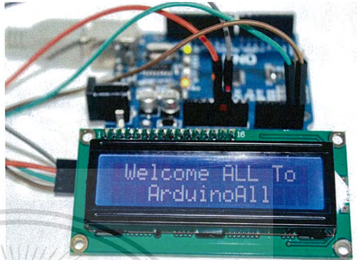
รูปที่ 3.15 ตัวอย่าง 1602 LCD (Blue Screen) 16x2 LCD และ backlight of the LCD screen พร้อม I2C Interface [20]
