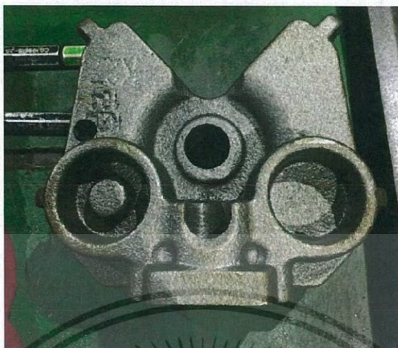
รูปที่ 3.9 เหล็กหล่อหลังผ่านกระบวนการของเครื่องจักรในเครื่องจักรที่ 2
