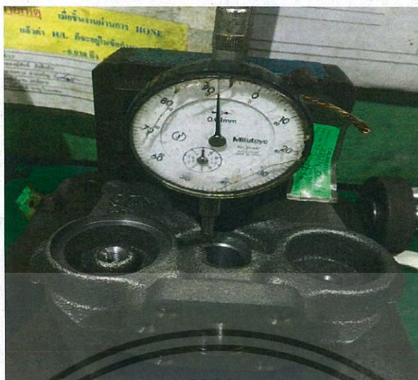
รูปที่ 3.12 วิธีการตรวจสอบลักษณะคุณภาพของความสูงทรีสเฟส
