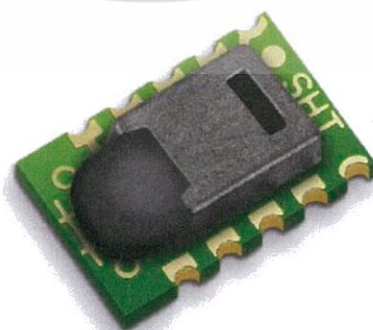
รูปที่ 2.28 อุปกรณ์ตรวจวัด SHT1X [11]
