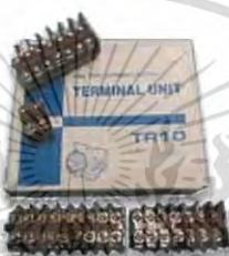
รูปที่ 3.7 รูปถ่ายจากอุปกรณ์จริงของเทอร์มินอลบล็อก
