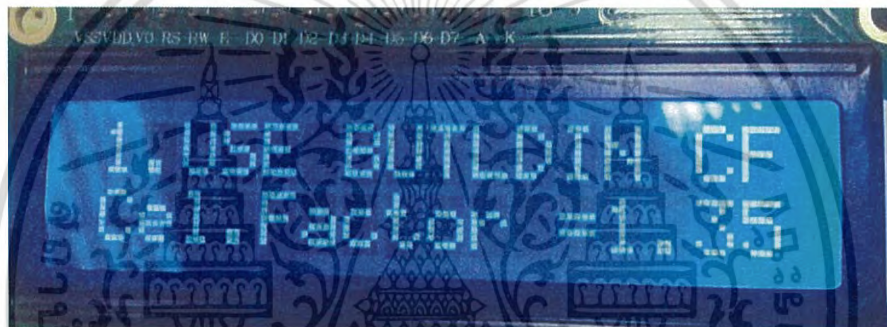
รูปที่ 4.7 หน้าจอแสดงการกด 1 เลือกโหมดการเลือกใช้ค่าสอบเทียบมาตรฐานจากระบบ
