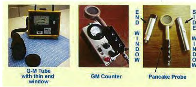
รูปที่ 2.4 เครื่อง GM counter และหัววัดรูปแบบต่างๆ
