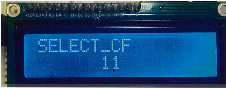
รูปที่ 4.9 หน้าจอแสดงเมื่อกด 2 เลือกโหมดการเลือกใช้ค่าสอบเทียบมาตรฐานจากการป้อนค่าจาก ผู้ใช้งาน
