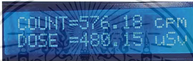
รูปที่ 4.11 ก การเลือก ค่า Calibration Factor เป็น 1.20
