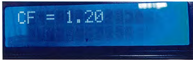
รูปที่ 4.11 ก การเลือก ค่า Calibration Factor เป็น 1.20
