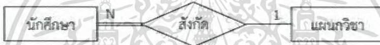
รูปภาพที่ 2.11 แสดงความสัมพันธ์ระหว่างเอนทิตีนักศึกษาและเอนทิตีแผนกวิชา
