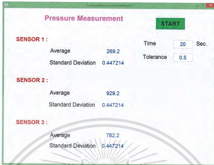
รูปที่ 4.2 หน้าจอแสดงผลหลังการให้แรงกดแก่ตัวเซนเซอร์วัดแรง
