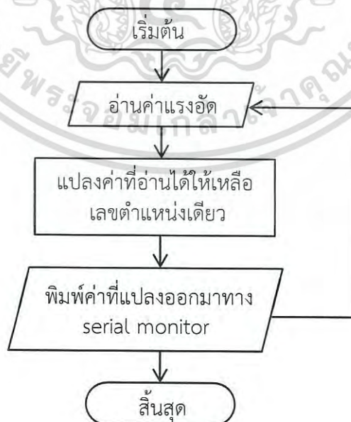
รูปที่ 3.4 การออกแบบผังงานของโปรแกรม Arduino
