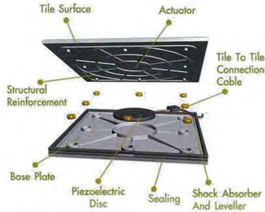
รูปที่ 2.10 แผ่นพื้นเพียโซอิเล็กทริกเก็บเกี่ยวพลังงานจากแรงสั่นสะเทือน
