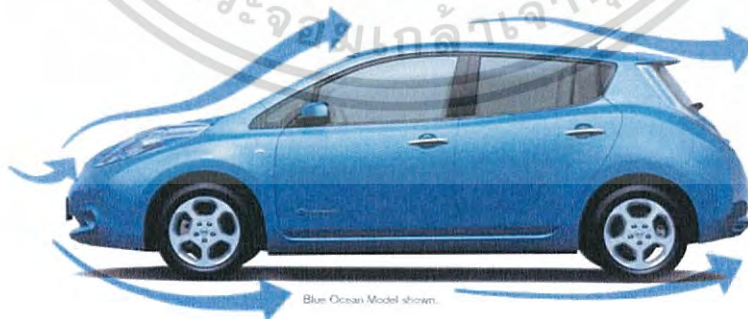
รูปที่ 2.2 ลมที่ผ่านตัวรถขณะเคลื่อนที่อาจทำให้เกิดเสียงรบกวนบริเวณประตูรถได้ (project7.ir, 2010)
