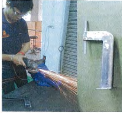
รูปที่ 3.18 การนำตัวเครื่องกดประตูลูกที่ผ่านการเชื่อมมาเจียรตกแต่ง
