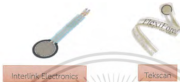
รูปที่ 2.9 เซ็นเซอร์ตรวจจับแรงกดจากบริษัท Interlink Electronic และ Tekscan
