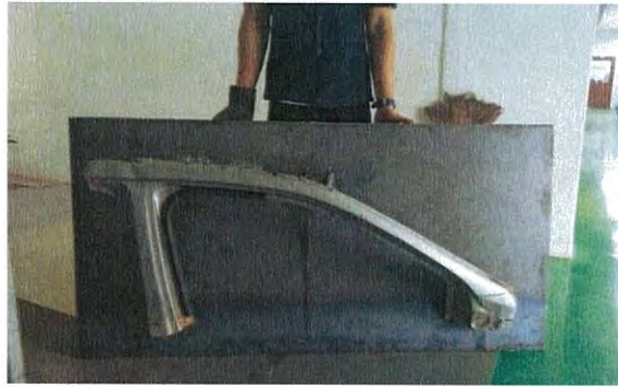
รูปที่ 3.13 ประตู่ที่ถูกเชื่อมติดบนแผ่นเหล็ก
