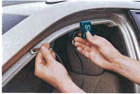
รูปที่ 2.5 การวัดระยะห่างระหว่างประตูด้วย Displacement Sensor (mantracout.com, 2017)
