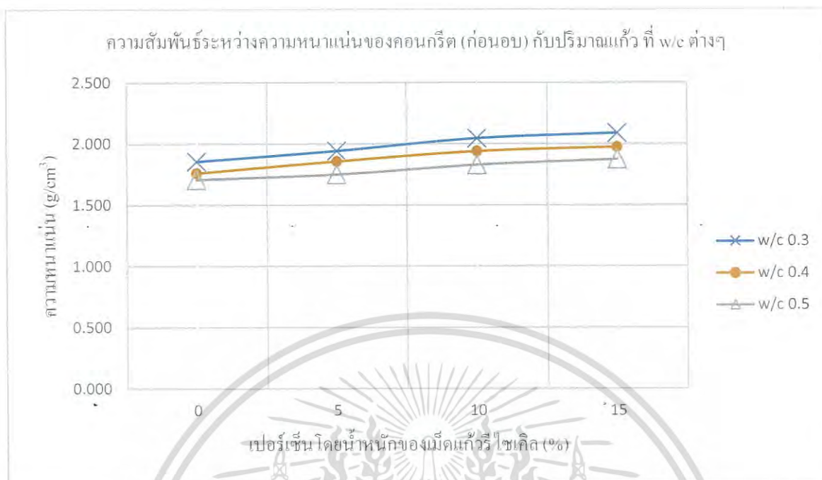
รูปที่ 4.1.4 ความสัมพันธ์ระหว่างปริมาณเม็ดแก้วรีไซเคิลกับหน่วยน้ำหนักที่อัตราส่วนน้ำต่อซีเมนต์
