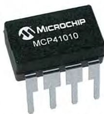
รูปที่ 3.12 digital potentiometer เบอร์ MCP41010
