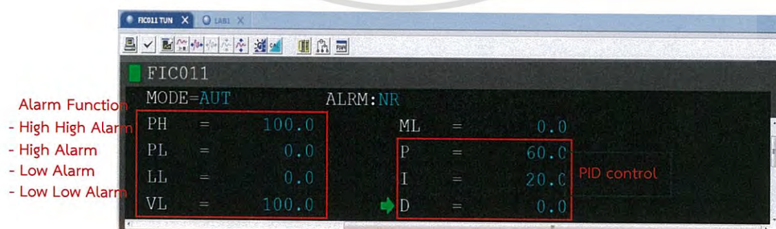
รูปที่ 4.2 การกำหนดค่าเทอมของสัดส่วน-ปริพันธ์-อนุพันธ์
