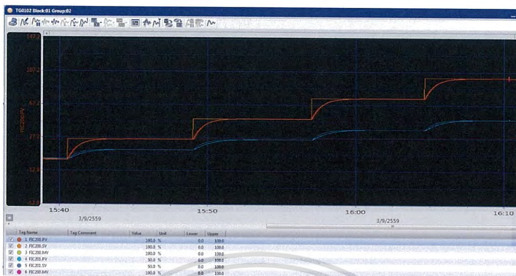
รูปที่ 4.7 ผลการทดลองควบคุมอัตราการไหลขาขึ้น : การควบคุมอัตราการไหลโดยใช้การควบคุมแบบอัตราส่วนด้วยตัวควบคุมแบบพีไอดี
