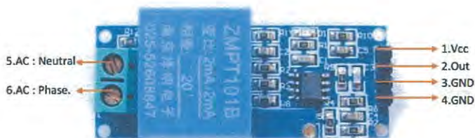
รูปที่ 2.5 การจัดขาของโมดูลเซนเซอร์วัดแรงดันไฟฟ้า ZMPT101B (Yanuar M, 2017) เอกสารนี้เป็นเอกสารที่สงวนลิขสิทธิ์โดยผู้ประพันธ์เนื้อหา กรุณาแจ้งเจ้าของเอกสารทุกครั้งที่มีการนำไปใช้ ไม่ว่ากรณีใดๆ ทั้งสิ้น อีกทั้งห้ามมิให้ดัดแปลงเนื้อหา และต้องอ้างอิงถึงเจ้าของเอกสารทุกครั้งที่มีการนำไปใช้
