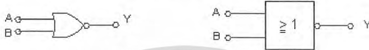
ข) แสดงสัญลักษณ์ของ NOR gate 2 input รูปที่ 2.11 การทำงานของ NOR Gates
