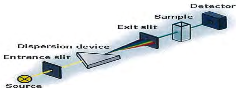
รูปที่ 2.5 แสดงส่วนประกอบของเครื่อง UV-VIS Spectrophotometer [7]
