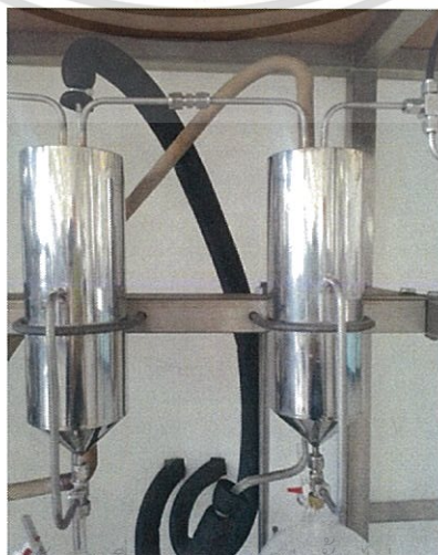
รูปที่ 3.11 Condenser
