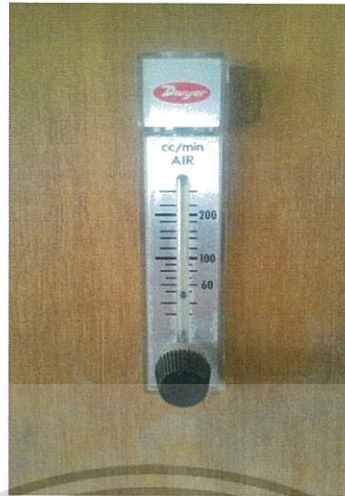
รูปที่ 4.4.4 Mass Flow Controller แบบ Analog สำหรับต่อเข้ากับขวดแก้ว
