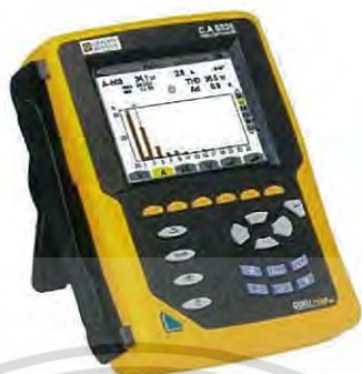
รูปที่ 3.10 เครื่องวิเคราะห์พลังงานไฟฟ้ารุ่น C.A.8335 ของบริษัท CHAUVIN ARNOUX GROUP
