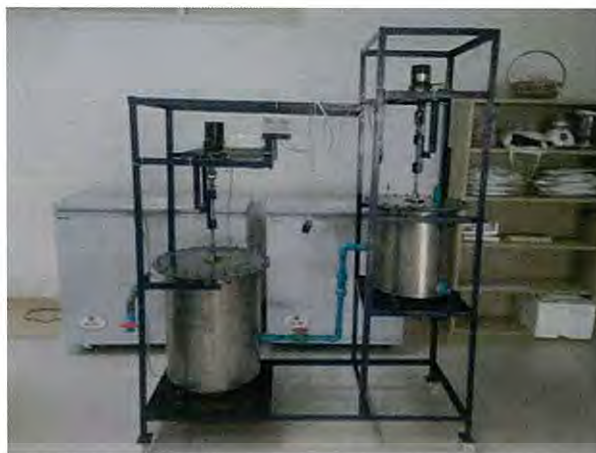
รูปที่ 3.3 ถังหมักแบบสองชั้นตอนที่ใช้ในห้องปฏิบัติการ
