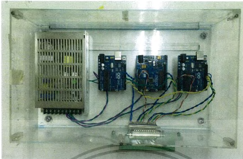
รูปที่ 3.5 กล่องที่ใช้สำหรับใส่อุปกรณ์และบอร์ดไมโครคอนโทรลเลอร์
