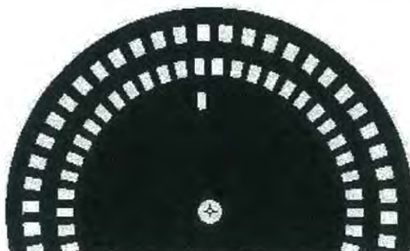
รูปที่ 2.10 ตัวอย่างแผ่น Disc ของเอ็นโค้ดเดอร์แบบ Incremental (1)
