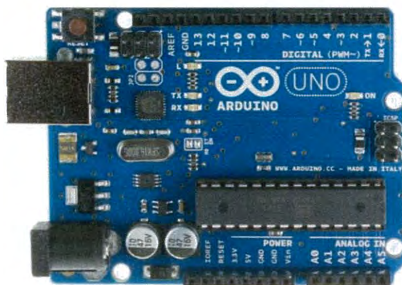
รูปที่ 3.3 ไมโครคอนโทรลเลอร์ Arduino Uno R3
