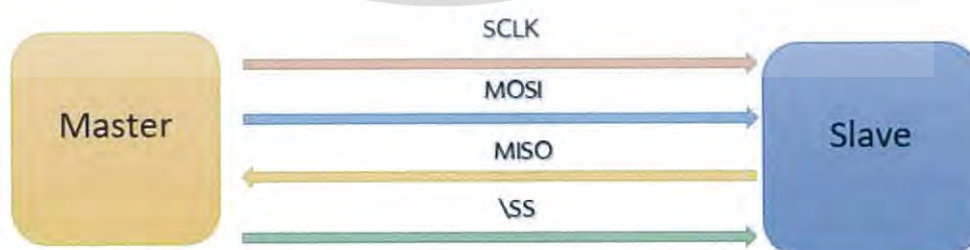
รูปที่ 2.7 การเชื่อมต่อการสื่อสารแบบ SPI ระหว่างอุปกรณ์ Master – Slave โดยมีสายสัญญาณ 4 เส้น
