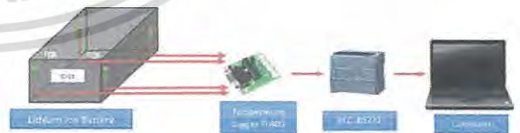
รูปที่ 3 การเชื่อมต่ออุปกรณ์เพื่อหาแบบจำลองทางอุณหภูมิของแบตเตอรี่ ขณะอัดประจุ
