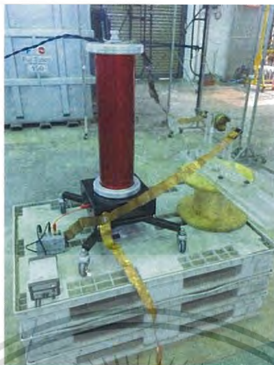
รูปที่ 4.22 วงจรทดสอบการเกิดการดิสชาร์จบางส่วนภายในเนื้อฉนวน โดยใช้อุปกรณ์ส่งสัญญาณที่ใช้เป็นตัวอ้างอิง
