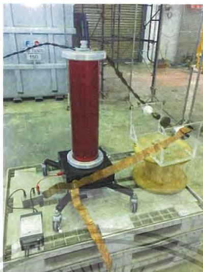
รูปที่ 4.10 วงจรทดสอบการเกิดการดิสชาร์จบางส่วนแบบโคโรนาด้านแรงดันไฟฟ้าสูงโดยใช้ อุปกรณ์ส่งสัญญาณที่ได้ทำการพัฒนาขึ้น
