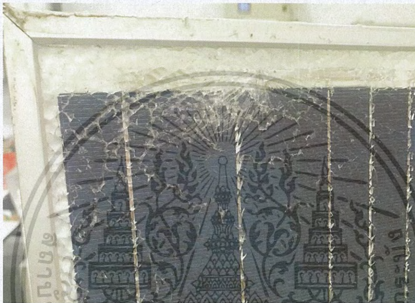
รูปที่ 4.8 แผงเซลล์แสงอาทิตย์ที่มีการเสื่อมสภาพจากการแตกหัก
