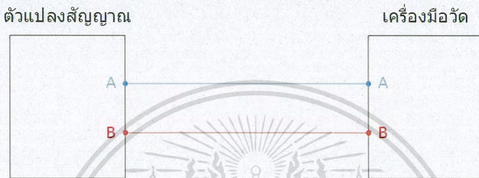
รูปที่ ก.2 ตัวอย่างการเชื่อมต่อ RS485 ระหว่างเครื่องมือวัดกับตัวแปลงสัญญาณ
