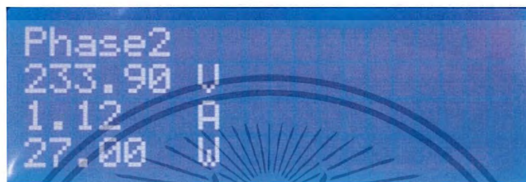
รูปที่ 4.14 หน้าแสดงผลแบบเรียลไทม์บนจอ LCD กรณีแรงดันสูงกว่าปกติ เฟส 2
