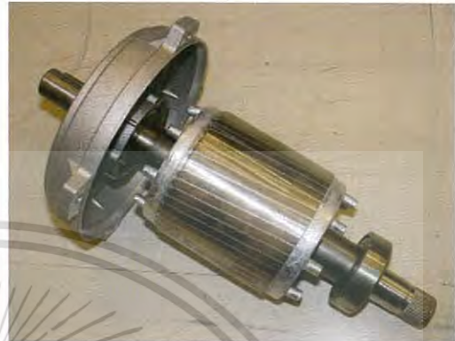
รูปที่ 2.3 โรเตอร์แบบพันขดลวด
