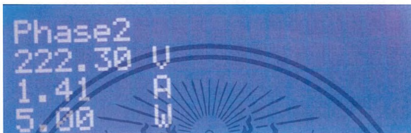
รูปที่ 4.19 หน้าแสดงผลแบบเรียลไทม์บนจอ LCD กรณีแรงดันไม่สมดุล เฟส 2
