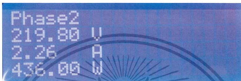
รูปที่ 4.24 หน้าแสดงผลแบบเรียลไทม์บนจอ LCD กรณีโหลดเกิน เฟส2
