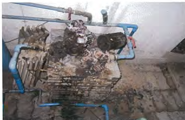
รูปที่1.2 มอเตอร์ไหม้ เนื่องจากแรงดันต่ำกว่าและกระแสในมอเตอร์สูง
