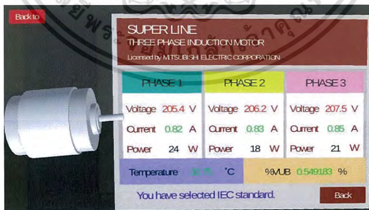
รูปที่ 4.7 หน้าแสดงผลแบบเรียลไทม์บนแอปพลิเคชัน AR กรณีแรงดันต่ำกว่าปกติ
