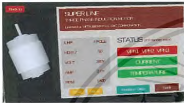
รูปที่ ก.4 สถานะการทำงานของมอเตอร์ผิดปกติ
